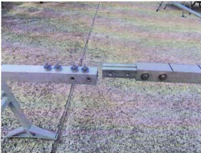
Boomkopplung vor dem Zusammensetzen Unconnected boom segments showing internal coupling
