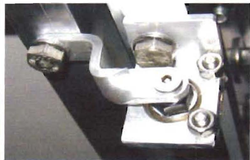
Ansicht Koax-Anschlußbuchse SO239 mit Strahler- element und Phasenleitung / view coax connector SO239 with driven element and phaseline
